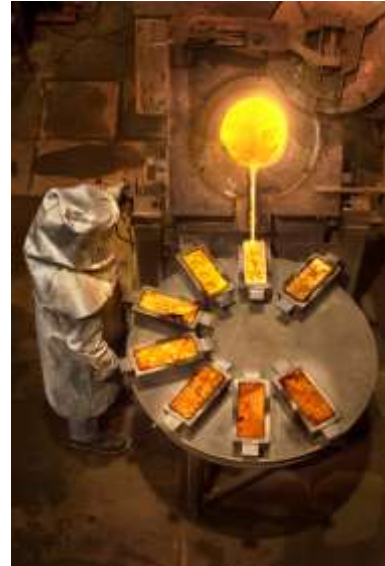
A gold pour at the Fort Knox Mine. (Photo courtesy Kinross Gold Corp.)
